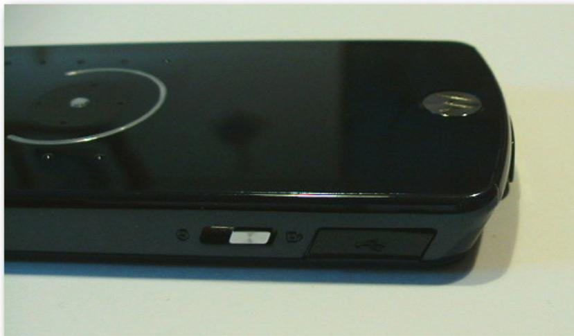
Die Tastensperre per Schieberegler. 🔍
